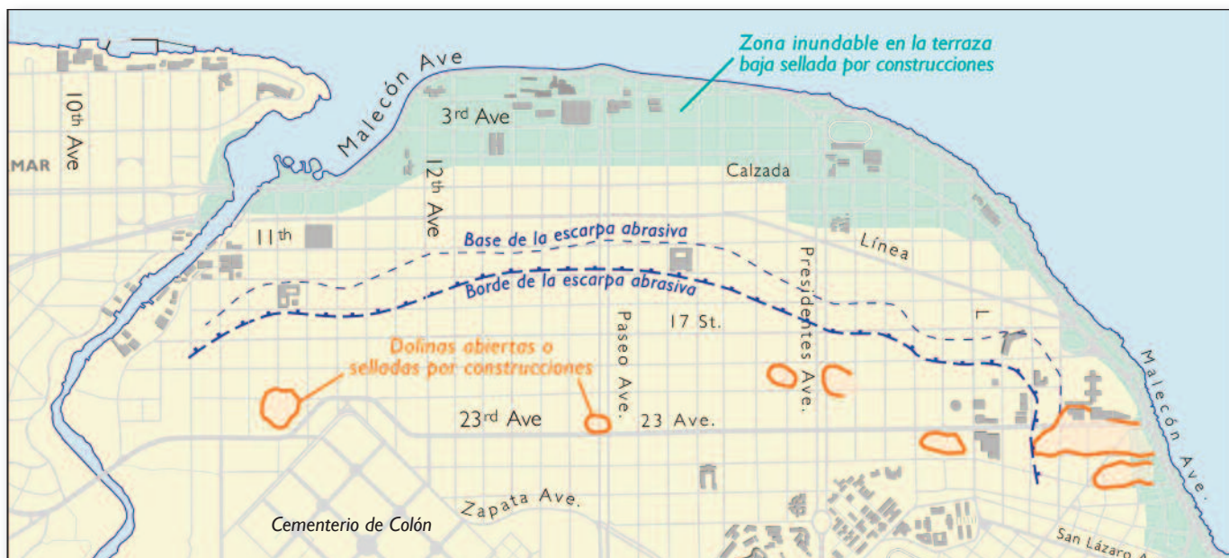
Figura 3. Algunas dolinas de la terraza abrasiva de 20 m en el Vedado fueron rellenadas para construir sobre o dentro de ellas; la superficie del karst quedó sellada por asfalto o concreto. La terraza inferior se inunda con facilidad por tiempo prolongado.
